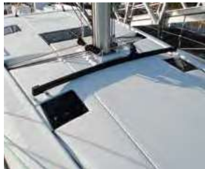
Self-tacking jib or staysail / Foc ou Trinquette sur rail auto vireur
