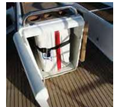
Dedicated liferaft locker with easy deployment / Coffre à BIB dédié avec mise à l'eau facile
